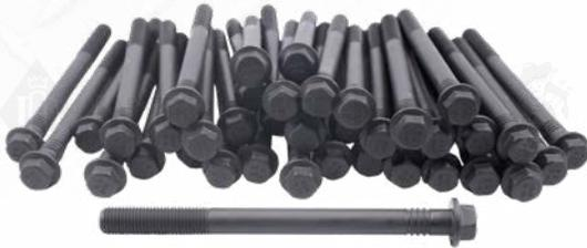
Interstate-McBee ahora ofrece el kit de repuesto de pernos de culata MCBD13HBK para aplicaciones de motores D13. Estos pernos son M16, grado 10.9, fabricados con acero tratado térmicamente de alta resistencia a la tracción y recubiertos de fosfato. Los 38 pernos de este kit se envían empaquetados de manera segura con protectores de rosca individuales para evitar daños.
